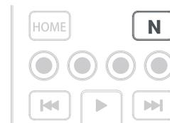
La télécommande Evolve est dotée d'un bouton NETTV permettant de visionner du contenu TV numérique, diffusé via Internet. Si votre télécommande d'origine était déjà pourvue d'un tel bouton (en effet, la télécommande de nombreux téléviseurs récents comporte un bouton Netflix, par exemple), le fonctionnement restera identique. Si ce n'est pas le cas,
